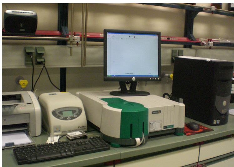
Slika 10: UV/VIS spektrofotometrom Varian 50 Conc, s pomočjo katerega smo našim spojinam izmerili absorpcijske spektre.
