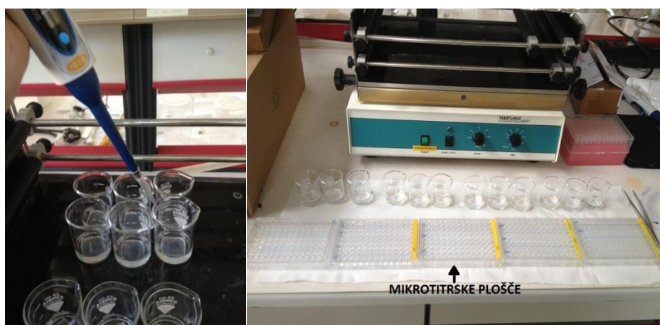
Slika 14: Odvzemanje vzorcev z različnimi vsebnostmi posamezne učinkovine v točno določenih časovnih intervalih in njihov prenos na mikrotitrne plošče
