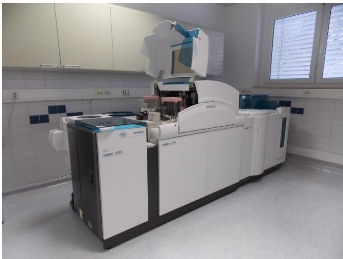
Slika 4: Biokemijski analizator: Cobas® Cobas 6000, Roche Diagnostics GmbH, Mannheim, Nemčija.
