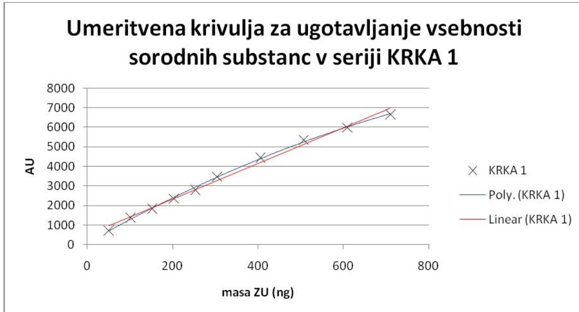
Slika 15: Umeritvena krivulja za ugotavljanje sorodnih substanc v seriji KRKA 1
