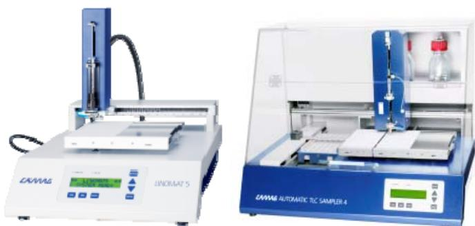
Slika 6: Primer polavtomatskega (levo) in avtomatskega (desno) nanašalnika proizvajalca Camag (29)
