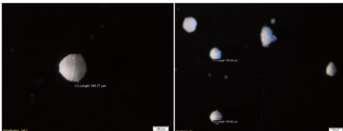
Slika 14: Vzorec K48 – frakcija 160–200 µm pod stereo mikroskopom pri 144x povečavi levo in 80x povečavi desno.
