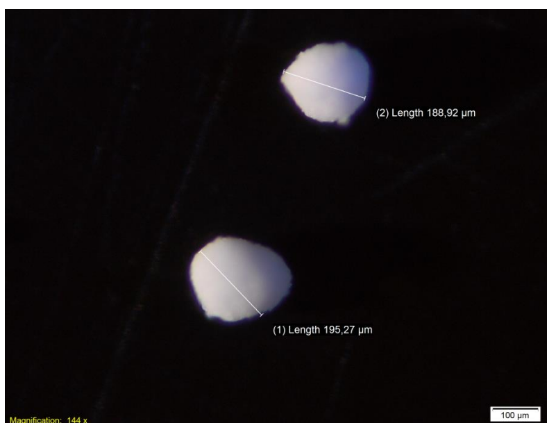
Slika 15: Vzorec K50 – frakcija 160–200 µm pod svetlobnim mikroskopom pri 144x povečavi.
