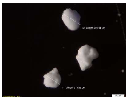
Slika 16: Vzorec K35 – frakcija 200–350 µm pod stereo mikroskopom pri 80x povečavi.
