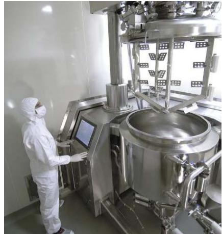
**Slika 19:** Vakuumski reaktor (29)
