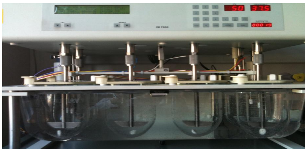
Slika 6: Naprava z vesli za sproščanje. Na kontrolni plošči sta vidna temperatura kopeli in število vrtljajev vesel. (Katja Lužar, 2012)
