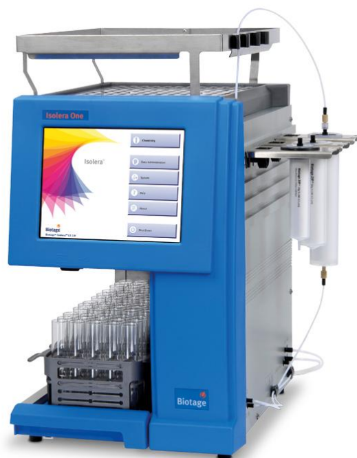
Slika 11: Aparat za izvedbo »flash« kromatografije, ki smo jo uporabili za ločevanje derivatov med seboj (27)
