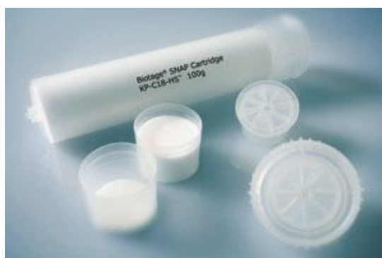
Slika 12: Slika prikazuje kartušo in nosilec na katerega se prenese vzorec reakcijske zmesi, ki se potem s pomočjo mobilne faze ločuje na kartuši (28).
