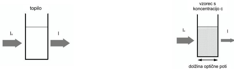
Slika 2: Razlika v intenziteti prepuščene svetlobe ( $I$ ). Leva slika prikazuje kiveto s topilom, desna pa kiveto z vzorcem s koncentracijo  $c$ . Pri prehodu skozi obarvano raztopino žarek oslabi. (25)
