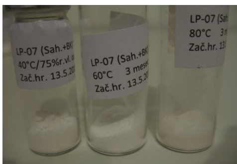
Slika 28: Videz binarne zmesi s saharozo po 3 mesečni izpostavljenosti 40°C/75% RH, 60°C in 80°C. Po 3 mesecih na pogoju 80°C se zmes s saharozo obarva rahlo rjavo, nekoliko manjše rjavo obarvanje pa je tudi vidno na pogoju 40°C/75% RH in 60°C.
