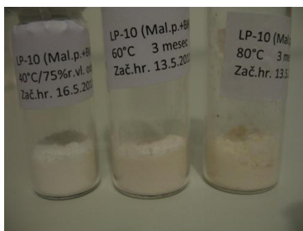
Slika 31: Videz binarne zmesi z praškastim maltitolom po 3 mesečni izpostavljenosti 40°C/75% RH, 60°C in 80°C. Na pogoju 60°C in 80°C se obarva rahlo rumeno rjavo.
