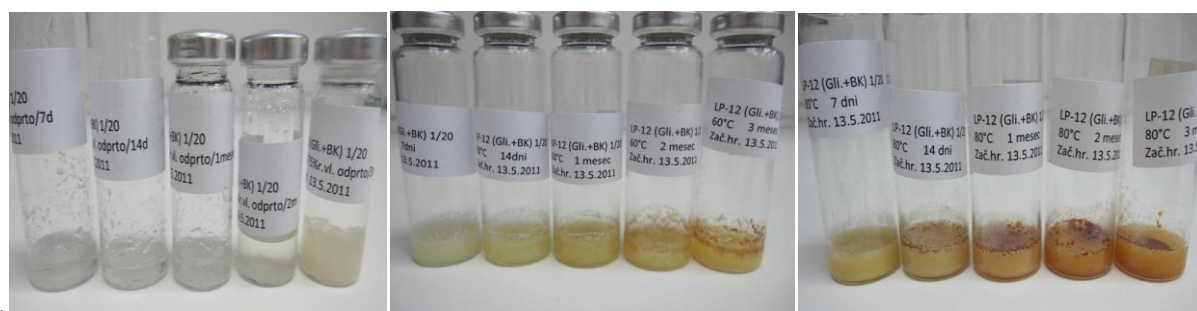
Slika 33: Videz binarne zmesi z glicerolom po 1 in 2 tedenski ter po 1, 2 in 3 mesečni izpostavljenosti 40°C/75% RH, 60°C in 80°C. Obarvanje, ki je vidno pri zmesi z glicerolom gre v smeri rumene oziroma na bolj stresnih pogojih (80°C) do rumeno rdeče.
