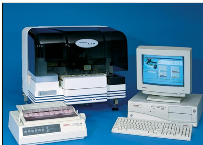
Slika 9: Analizator Personal LAB TM (Adaltis/Italija)
