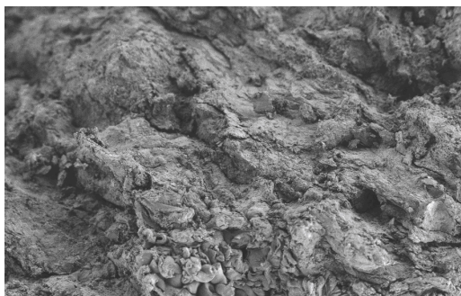
Slika 27: Elektronsko mikroskopska slika površine prereza jedra tablete št. 4 iz Al pretisnega omota, pri + 25 °C; 1000 X povečava.
