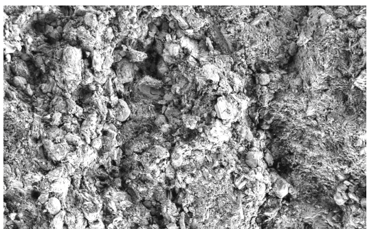
Slika 21: Elektronsko mikroskopska slika površine prereza tablete št. 3 iz Al vreče, pri + 25 °C; 1000 X povečava.
