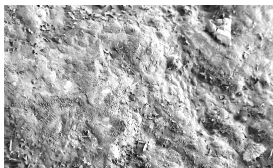
Slika 16: Elektronsko mikroskopska slika zunanje površine tablete št. 1, pri + 70 °C; 1000 X povečava.
