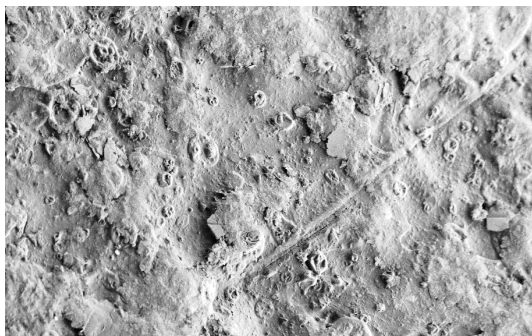
Slika 15: Elektronsko mikroskopska slika zunanje površine tablete št. 1, pri + 25 °C; 1000 X povečava.
