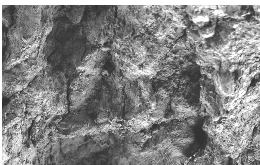
Slika 31: Elektronsko mikroskopska slika površine prereza jedra tablete št. 4 iz plastenke, pri + 25 °C; 1000 X povečava.
