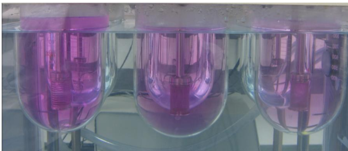
Slika 25: Prikaz procesa gibanja medija pri uporabi naprave za raztapljanje 2: A-vretena, B-vretena z japonsko košarico, C-vretena s konusno posodo.
