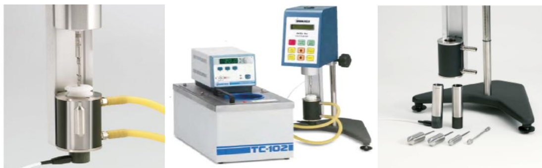
Slika 17: Rotacijski reometer Brookfield s pripadajočimi merilnimi deli ter termostatisirano vodno kopeljo, ki zagotavlja konstantno temperaturo med izvajanjem meritev (48).
