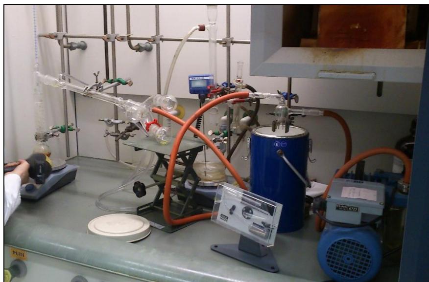
Slika 8: Aparatura za frakcionirno vakuumsko destilacijo.
