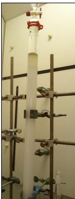
Slika 9: Kolona s SF in nanešenim vzorcem.
