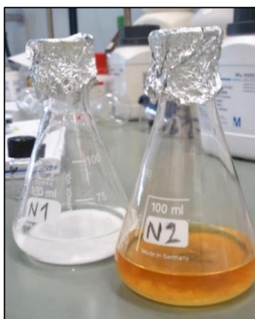
Slika 11: Produkta po končani ekstrakciji z dodanim sušilnim sredstvom.
