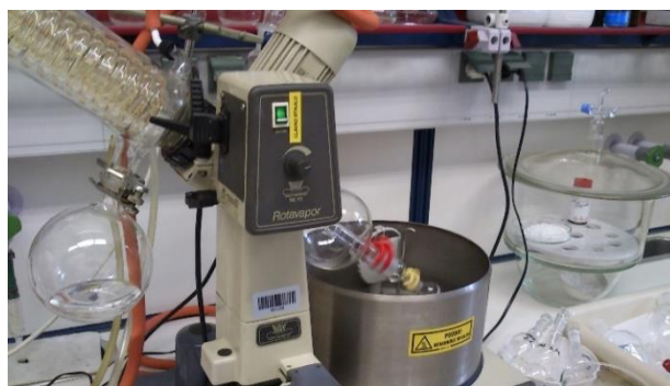
Slika 10: Odparevanje topila z rotavaporjem
