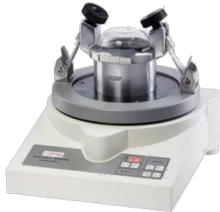
Slika 9: Vibracijski kroglični mlin – Fritsch, Pulverisette 0, prirejeno po (26).
