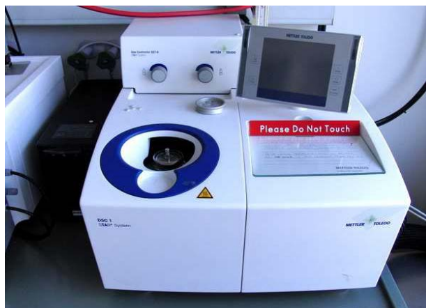
Slika 8: Diferenčni dinamični kalorimeter Mettler Toledo DSC 1, STAR e System.
