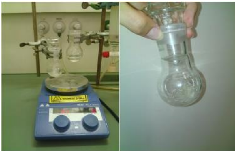
Slika 9: Mešanje zmesi pri sobni temperaturi ter produkt acetiliranja-brezbarvni trdni kristali.
