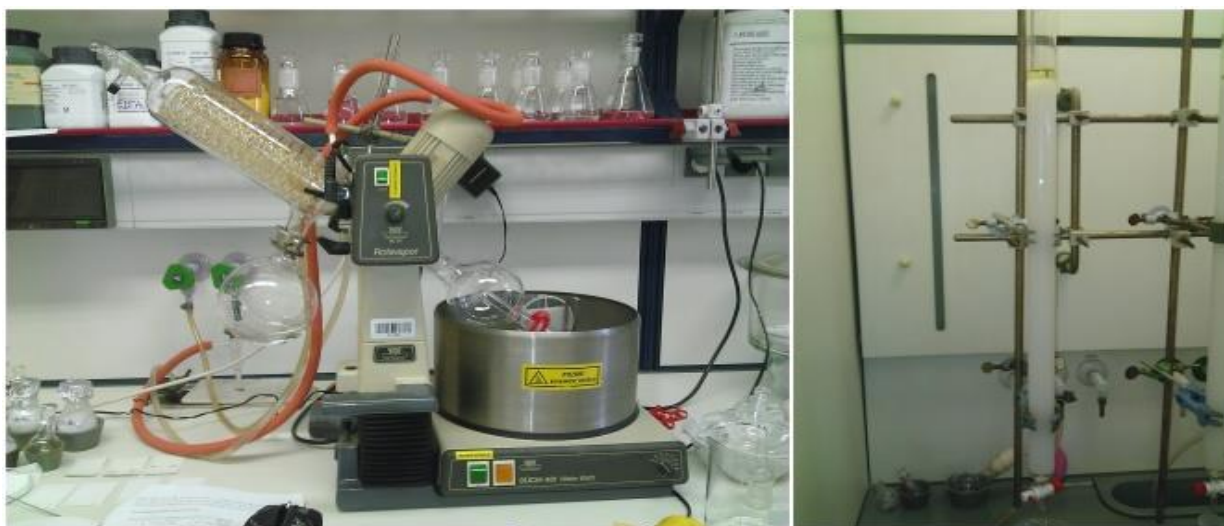
Slika 8: Aparatura za hitro destilacijo rotavapor ter čiščenje frakcije 1 z uporabo kolone.
