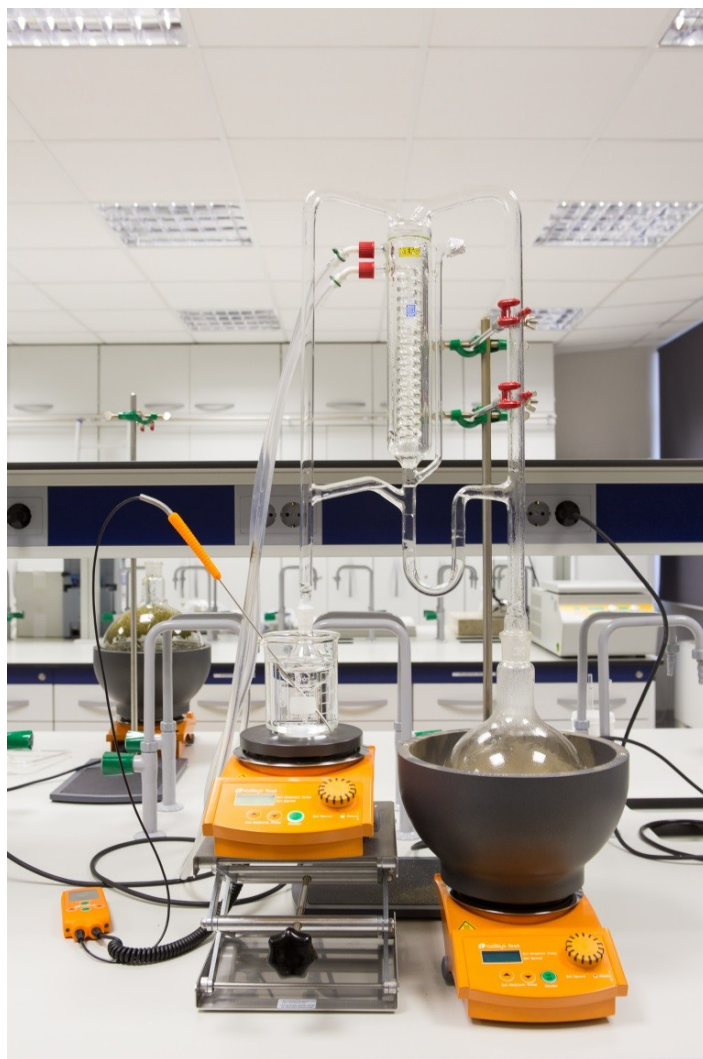
Slika 3: Aparatura za kodelilacijo (foto: Tomaž Strnišnik)
