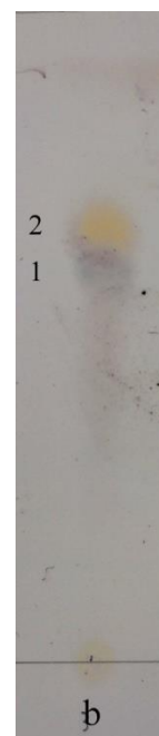
Slika 9: Kromatogram ekstrakta kreme Diprosone po orositvi z OR2 (b)
