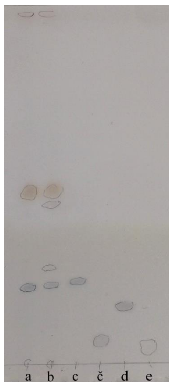
Slika 13: Kromatogram ekstraktov kreme Diprosone, Melema Dr. Vasića št. 1 ter raztopin standardov kortikosteroidov, razvit v mobilni fazi MF3 ter orošen z OR2. Oznake vzorcev: krema Diprosone (a), Melem Dr. Vasića št. 1 (b), raztopina standarda betametazondipropionata (c), raztopina standarda kortikosterona (č), raztopina standarda kortikosteronacetata (d) ter raztopina standarda prednizona (e).
