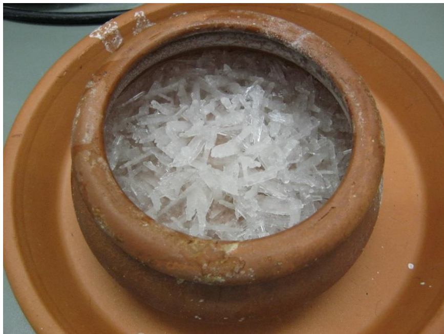
Slika 13. Kristali kalijevega nitrata v lončeni posodi po odlitju matičnice.
