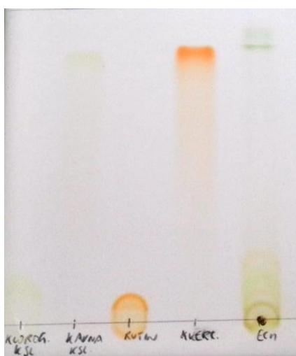
Slika 13. TLC kromatogram na vidni svetlobi s spremenjeno mobilno fazo (etil metanoat,
