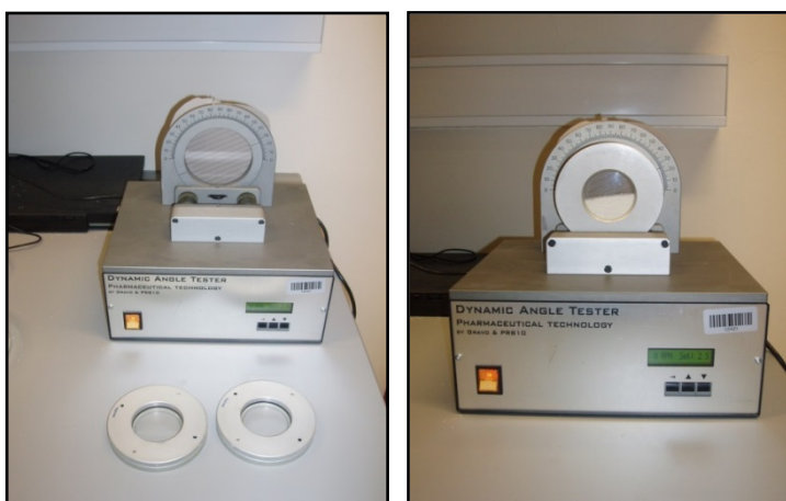
Slika 4: Levo – naprava Dinamic Angle Tester in razstavljen valjasti merilni vsebnik; desno – vzorec v merilnem vsebniku na napravi, pripravljen na začetek meritve
