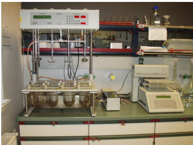
Slika 6: Naprava za sproščanje VanKel-7000 z veslastimi mešali in avtomatskim vzorčevalnikom
