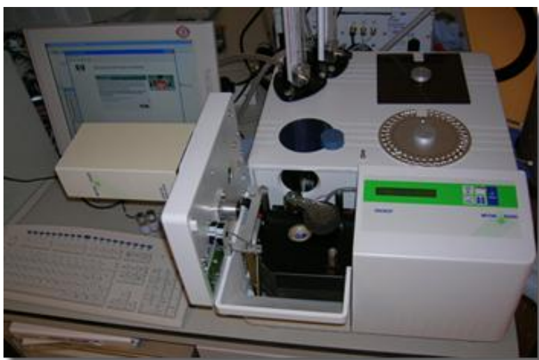
Slika 4: Diferenčni dinamični kalorimeter Mettler toledo z avtomatskim vzorčevalnikom in opremo za ohlajanje tekočega dušika (58).
