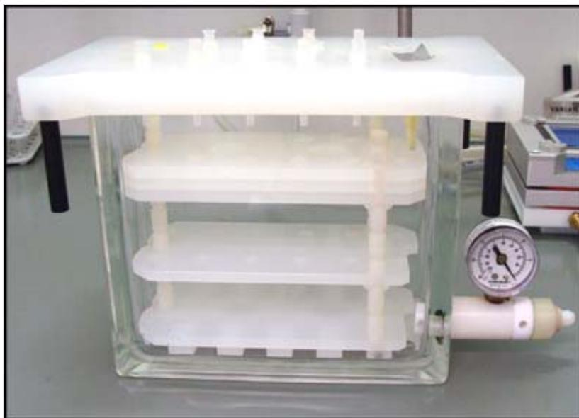
**Slika 2:** Vakuumski sistem z nastavki za SPE kartuše
