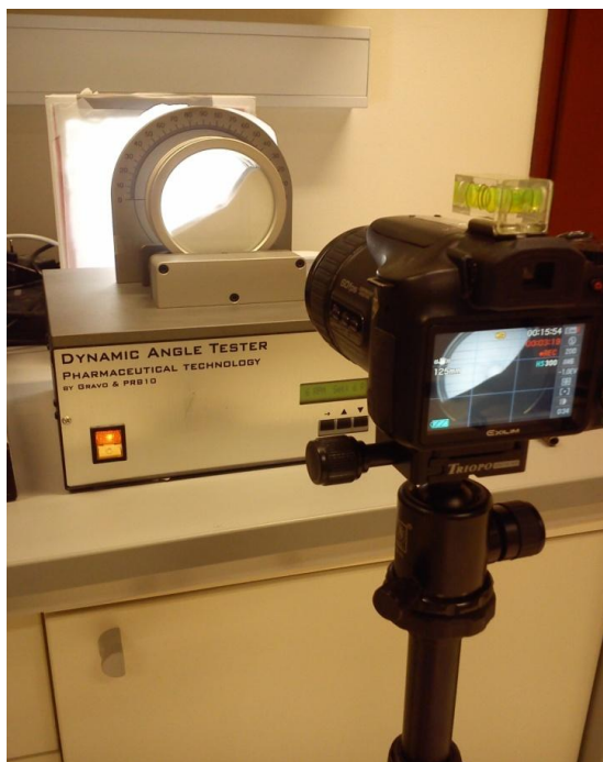
Slika 10: Določanje pretočnih lastnosti z vrtečim bobnom.
