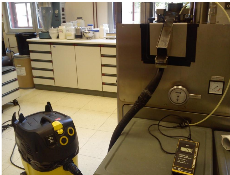
Slika 12: Prikaz ustvarjanja podtlaka s sesalcem.
