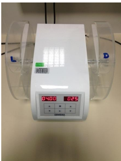
Slika 23: Naprava za določanje krušljivosti.
