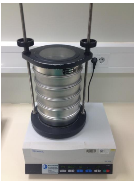
Slika 21: Naprava za izvedbo sejalne analize.
