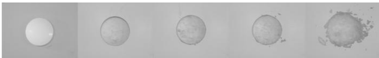
Slika 30: Razpad tablete, ki kot razgrajevalo vsebuje sušen koruzni škrob, kot polnilo pa laktozo, sušeno z razprševanjem, ob času 0, 30, 60, 90 in 300 sekund. Razpad je posnet v petrijevki.
