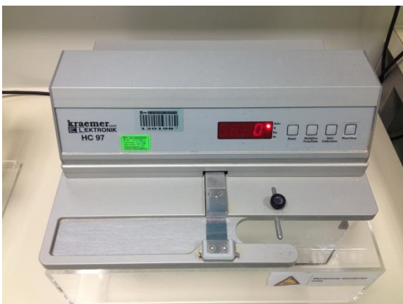
Slika 22: Naprava za merjenje trdnosti.
