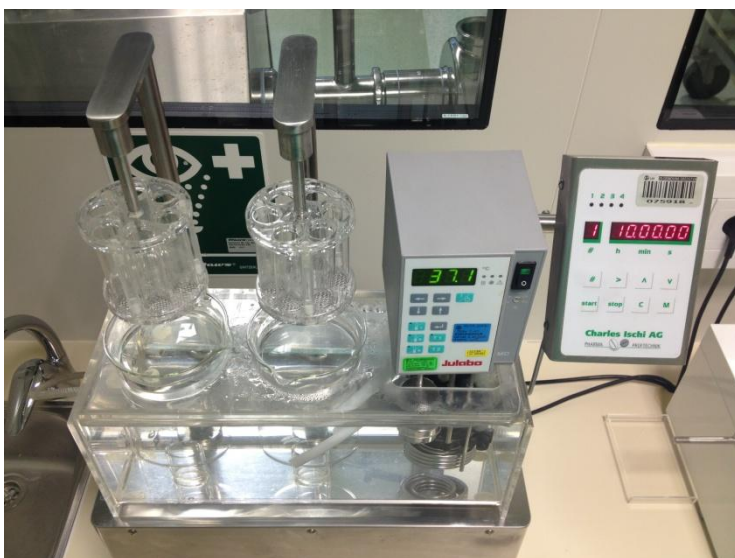
Slika 24: Naprava za merjenje razpadnosti tablet in kapsul.
