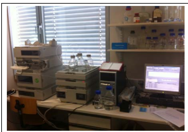
Slika 9: HPLC Agilent Series, na kateri smo preverjali vsebnost sproščene učinkovine.
