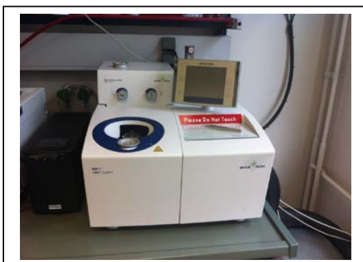
Slika 11: Diferenčni dinamični kalorimeter (DSC) s katerim smo izvedli termično analizo vzorcev.
