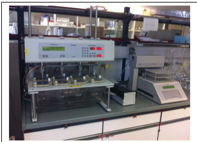
Slika 8: Levo je naprava za preskus sproščanja RSV, VanKel-7000, desno avtomatski vzorčevalnik.
