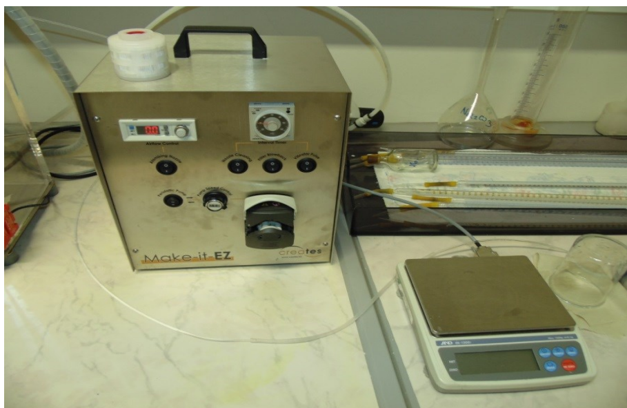
Slika 15: Črpalka za dotok zraka in vode ter tehtnica, s katero smo merili maso dodane vode.
