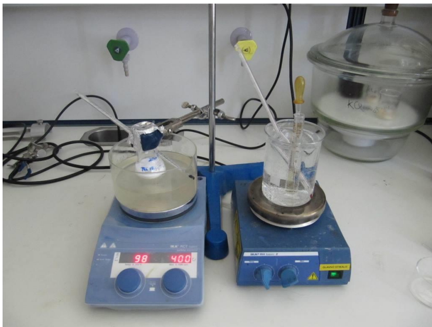
Slika 5: Izdelava TD karvedilola s polietilenglikolom in Neusilinom US2
