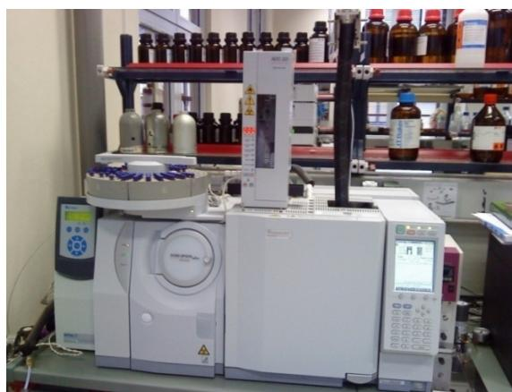
Slika 5: Aparatura GC-MS.
