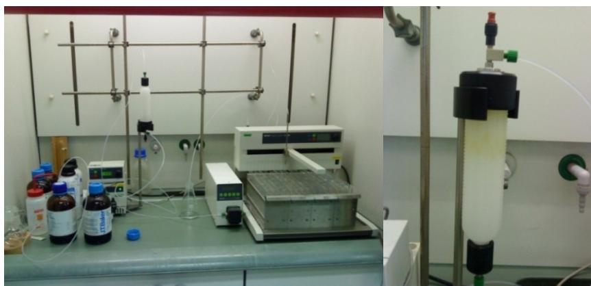
Slika 6: Aparatura za flash kolonsko kromatografijo
