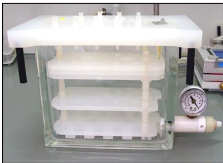
Slika 8. Vakuumski sistem z nastavki za SPE kartuše.
