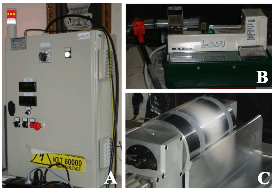
Slika 14: Generator visoke napetosti (A), plastična brizga s kovinsko iglo, vpeta v črpalko (B) in vrteče zbiralo (C).
