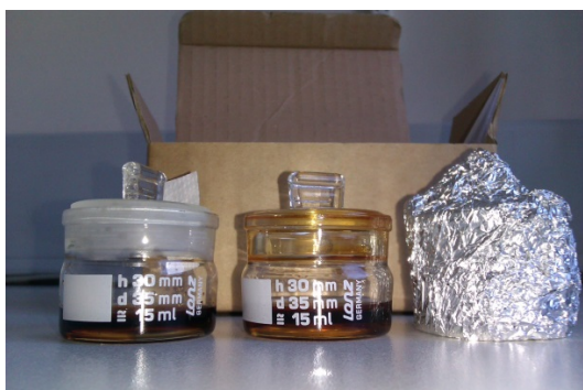
Slika 6: Vzorci TK, shranjeni v steklenih vsebnikih in pripravljeni na pogoje staranja (levo – UV lučka, sredina – svetloba, desno – tema).
