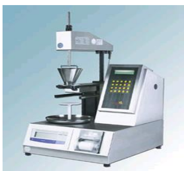
Slika 19: Aparatura Pharmatest PTGS za merjenje pretočnosti in nasipnega kota.
