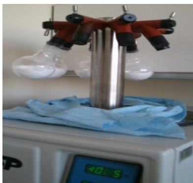
Slika 18: Nastavek za bučke liofilizatorja Lio 5P.
