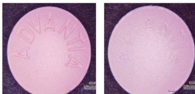
Slika 7: Na levi je tableta brez napake, na desni pa opazimo pojav imenovan "bridging" (20)
