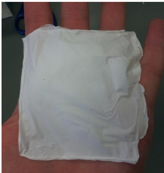
Slika 22: Krpica iz polikaprolaktonskih nanovlaken.
