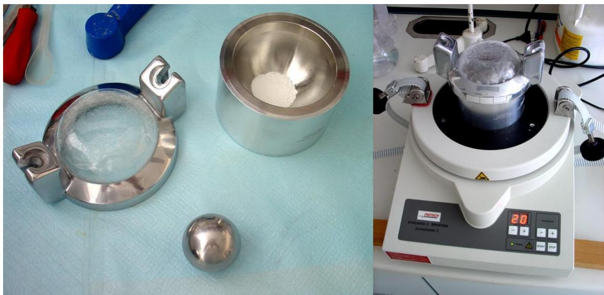
Slika 9: Vibracijski mlin Pulverisette 0 Fritsch (75).
