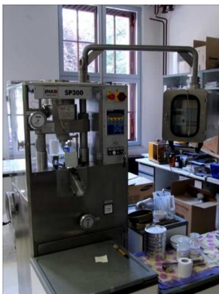
Slika 11: Tabletirka na udarec IMA Killian SP300.
