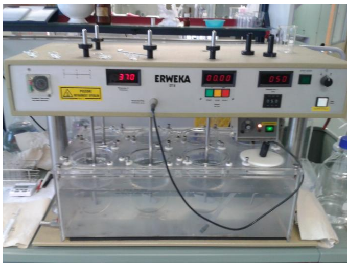
Slika 10: Naprava za raztapljanje Erweka DT6.
