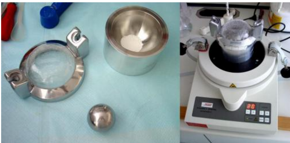
Slika 8: Vibracijski mlin Pulverisette 0, Fritsch.
