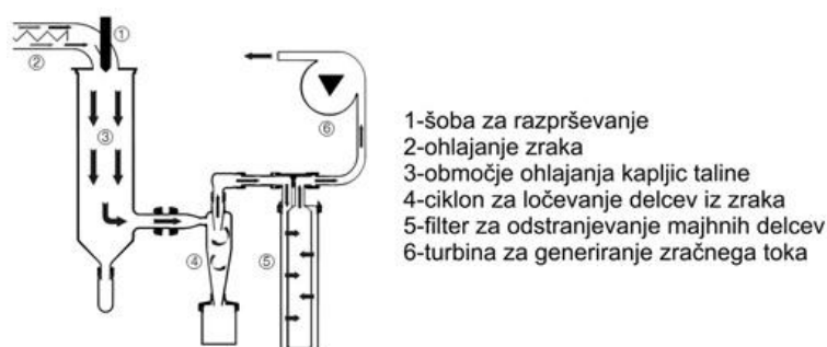
Slika 4: Shema aparata za izdelavo delcev z razprševanjem s strjevanjem
