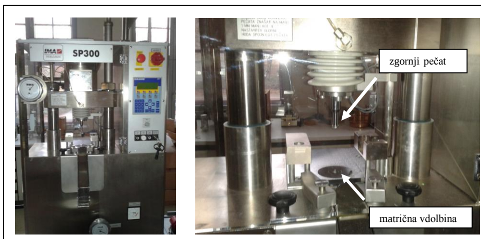
Slika 6: Instrumentirana tabletirka na udarec (Killian SP300) s pomočjo katere smo izdelali tablete.
