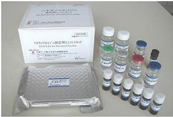
Slika 5: Sestava reagenčnega kompleta za metodo ELISA
