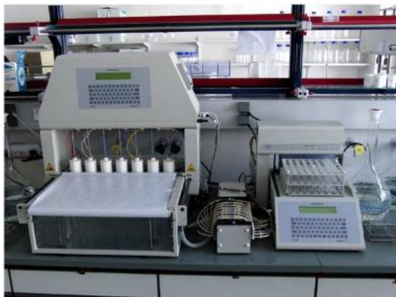
Slika 3: Naprava z recipročnimi cilindri, ki smo jo uporabljali za preskuse sproščanja (20)
