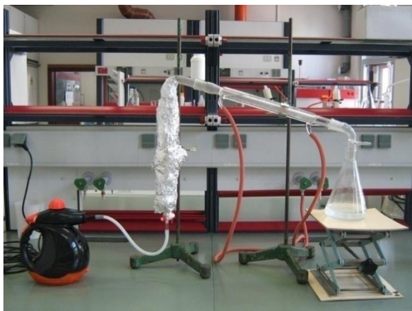
Slika 12: Sestavljena aparatura za parno destilacijo.
