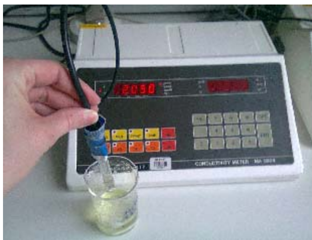
Slika 8: Merjenje prevodnosti raztopine polimera.
