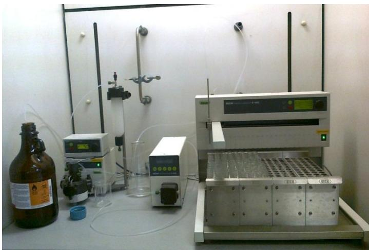
**Slika 6:** Aparatura za kolonsko kromatografijo
