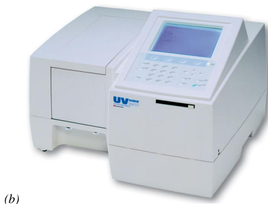
Slika 15: (a) Zgradba enožarkovnega spektrofotometra. (b) Aparatura Shimadzu UV mini 1240.
