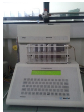
Slika 9: Avtomatski vzorčevalnik VK 8000.
