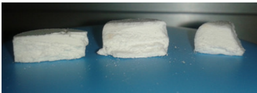
Slika 44: Liofilizirane tablete iz HPMC K100LV (od leve proti desni): suha tableta, tableta po 30 min sproščanja in tableta po 2 h sproščanja.
