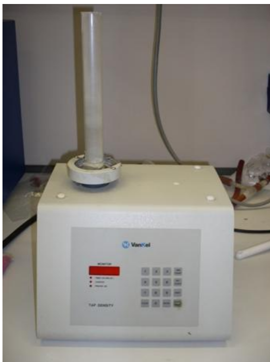
Slika 4: Naprava za določanje zbite gostote
