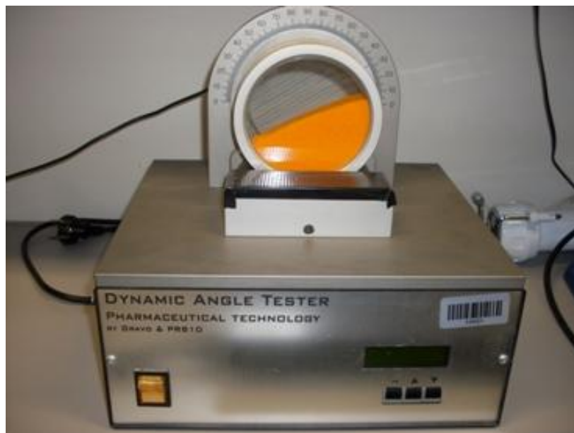
Slika 3: Naprava za merjenje dinamičnega nasipnega kota z vrtečim bobnom
