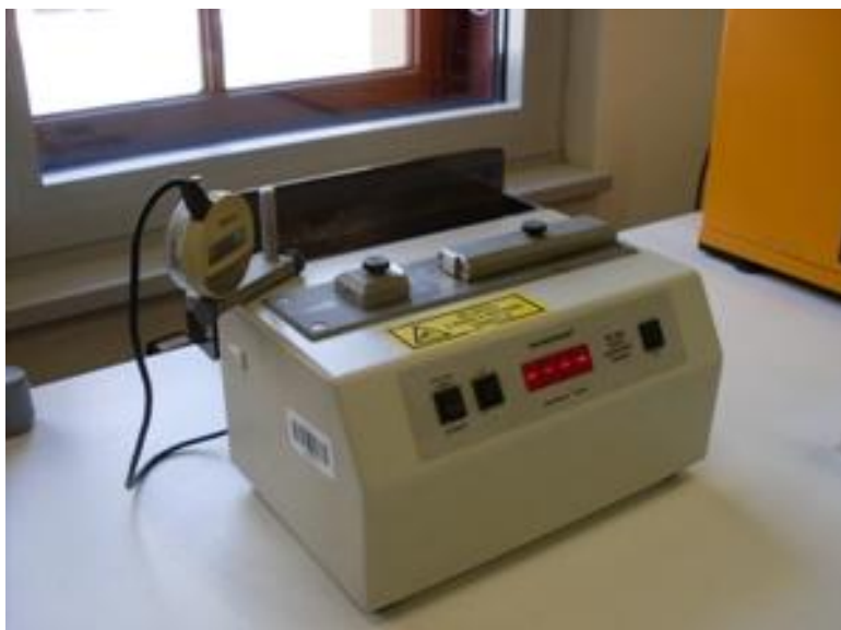
Slika 2: Aparat za določanje trdnosti tablet.
