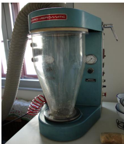
Slika 13: Sušenje mikrokapsul v vrtninoslojnjem sušilniku.
