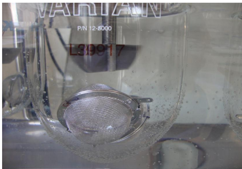
Slika 14: Mrežasti vsebniki za določanje nabrekanja in erozije.
