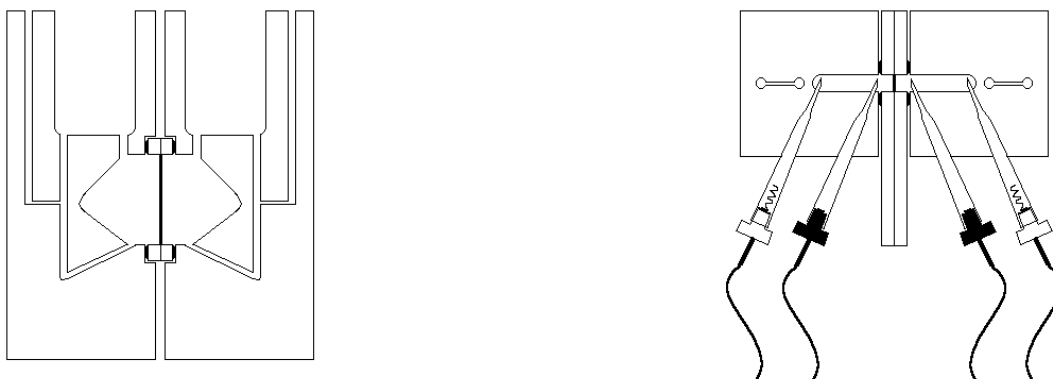
Slika 8: Shematski prikaz Sweetana-Grass difuzijske celice (levo) in priključka elektrod v celico (desno) (37)
